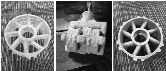
(a) 模样 (b) 型壳 (c) 钛合金构件
